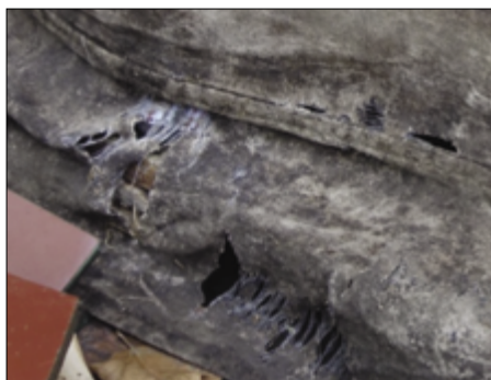
Acoperișul (stînga) și perețele lateral (centru și dreapta) ale cortului, care prezentau găuri erodate și destrămări, presupus a fi provocate de substanța cu care a fost stropit de persoane necunoscute.
